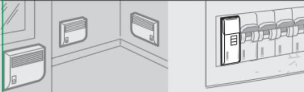
Pour délester des appareils de puissance en association avec un appareil de commande (ex : horloge programmable)
