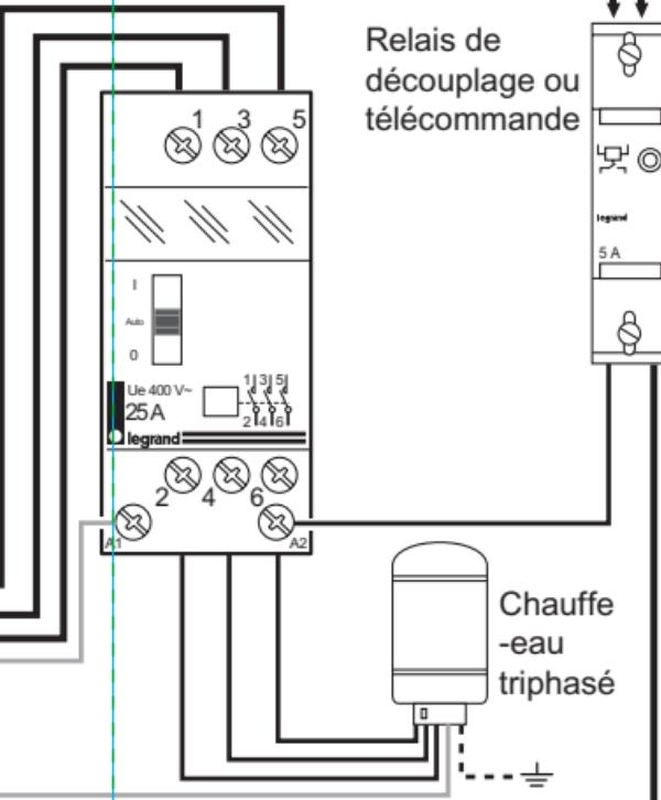
Partie raccordée par les services du distributeur d'énergie (ex : EDF)
