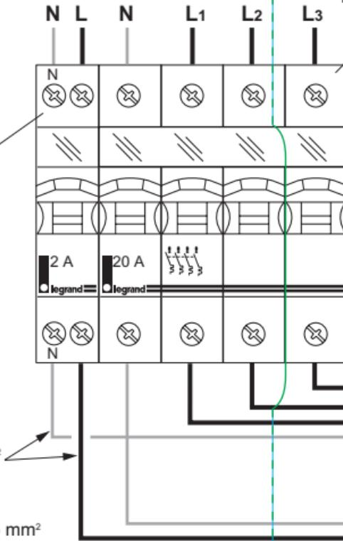
Protection de la ligne pilote par un disjoncteur 2 A Réf. 928 20
