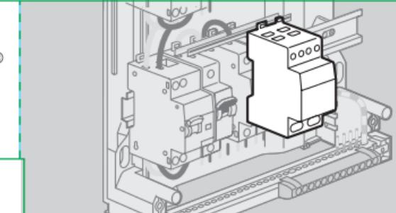
Pour mettre en marche automatiquement un chauffe-eau triphasé, pendant les heures creuses du distributeur d'énergie (ex : EDF).
