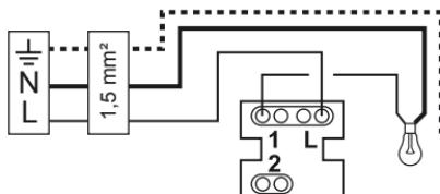
En va-et-vient, commande de 2 endroits différents.
