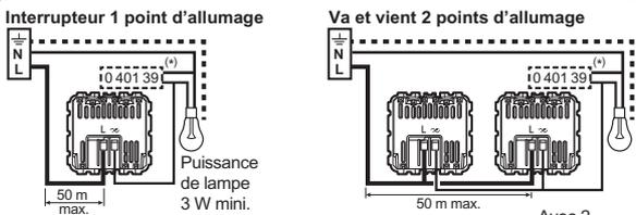
Avec 2 détecteurs, puissance de lampe 10 W mini.
