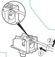
La languette métallique du mécanisme doit être en contact avec le blindage de terre du câble utilisé (film ou tresse métallique).
