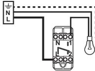
En va-et-vient, commande de 2 endroits différents
