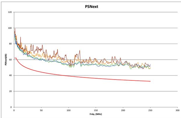
■ 9.3 Performances en lien permanent avec un connecteur Cat 6<sub>A</sub> STP et un câble Cat 6<sub>A</sub> U/FTP
