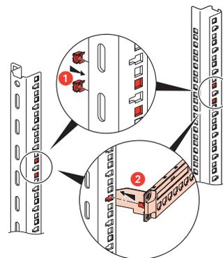
Astucieux : système permettant de pré-positionner et pré-maintenir le panneau sans avoir à le visser.
