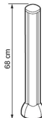
560mm de disponible par face sur la colonnette pour l'installation des blocs.
