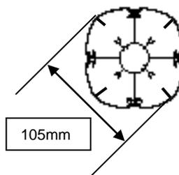
Pour connaître l'encombrement d'un bloc colonne monté sur une face, il faut ajouter 25mm d'encombrement par compartiment. Exemple :
