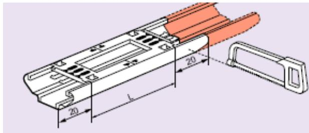
Pour équiper vos colonnes, munissez-vous d'un bloc-colonne réf. 0 307 13 pour support d'appareillage. Faites l'inventaire des prises à installer, optez pour un ou plusieurs support d'appareillage et déterminez grâce au tableau ci-dessous la longueur du bloc dont vous avez besoin. Prévoir en plus de la longueur « L » 20 mm de chaque côté du bloc pour la pose des embouts réf. 30714
