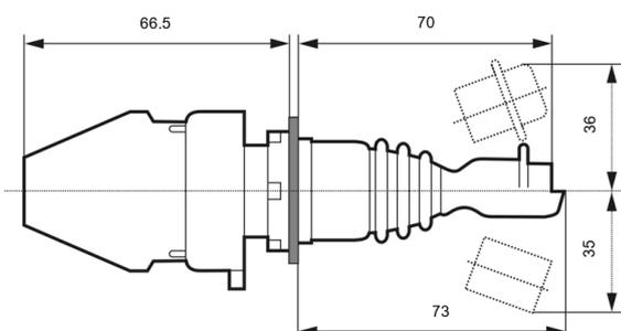
Schéma de fonctionnement des manipulateurs à tige
