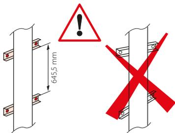
Le coffret peut être fixé sur châssis : réf. 0 577 44
