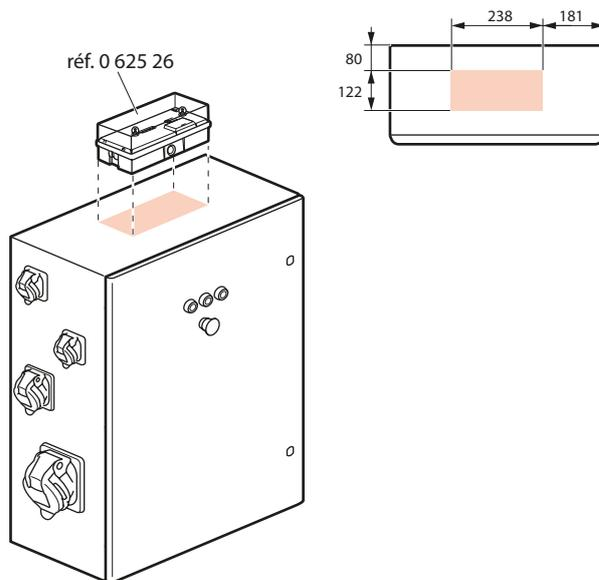
Le coffret de distribution équipé d'un BAES peut également être fixé sur châssis
