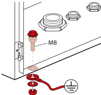
Raccordement de terre extérieure sur vis M8 x 30
