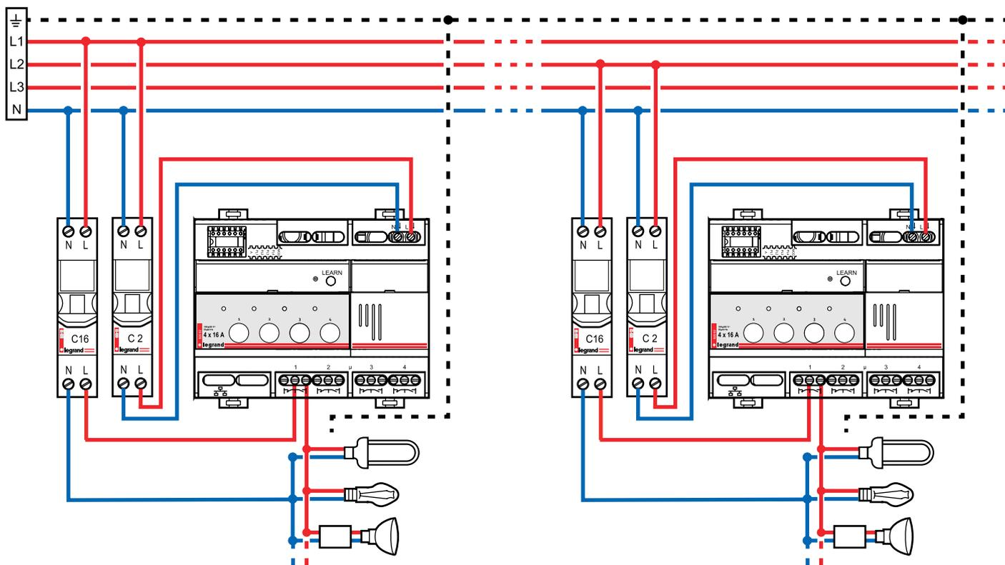
**IMPORTANT** : Ce produit doit être utilisé sur une seule phase pour respecter la coupure au zéro secteur. Les contacts de sorties utilisent la même phase d'alimentation.
