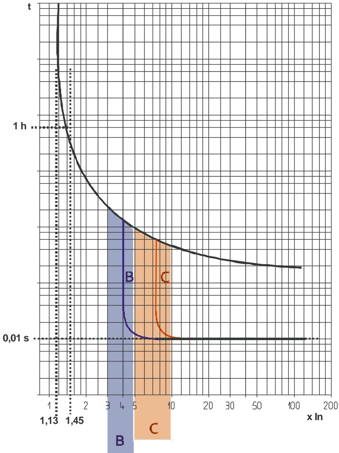
Déclenchement thermique à température ambiante = 30°C
