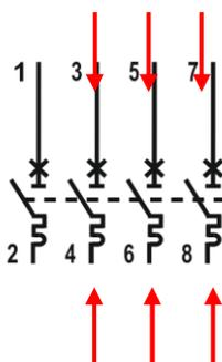
Il est possible de remplacer un disjoncteur au milieu d'une rangée peignée sans déconnecter les autres produits
