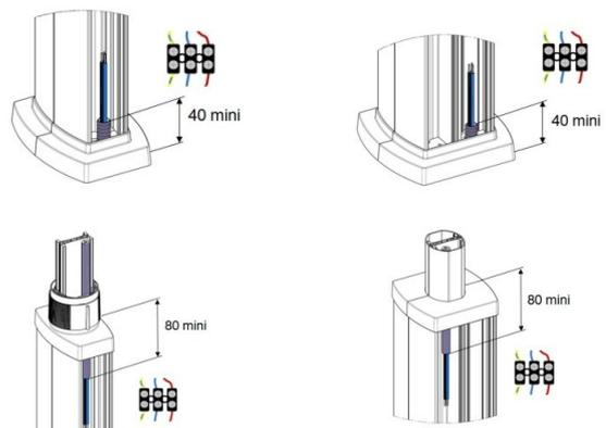
L'arrivée des câbles peut être réalisée par le sol, via faux plancher/passage de plancher, ou par le plafond.
