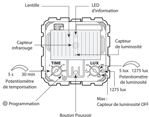
**Détecteurs automatiques 2 fils 100 VA LED****Détecteurs automatiques 3 fils 500 VA LED****6. CARACTÉRISTIQUES TECHNIQUES****■ 6.1 Caractéristiques générales**
