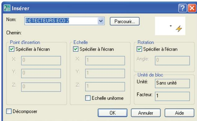
Cochez **Spécifier à l'écran** pour **Point d'insertion**, **Échelle**, et **Rotation** afin que l'insertion s'effectue à l'écran avec le curseur.
