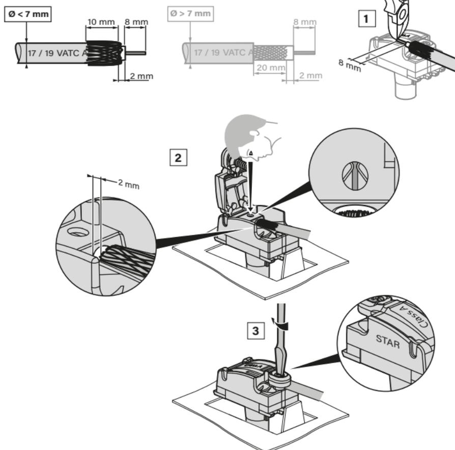
Utiliser du câble coaxial  $\text{Ø}$  5,5 à 7 mm
