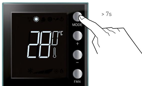
Lorsque l'écran affiche A => le thermostat est en mode Automatique (pour que ce mode soit accessible, il faut activer la commutation automatique dans la configuration du thermostat, onglet "avancé")
