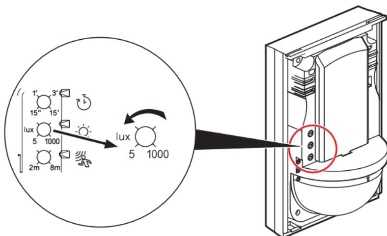
Pour que le détecteur se déclenche uniquement lorsqu'il fait sombre, tournez la vis (potentiomètre) dans le sens inverse des aiguilles d'une montre.
