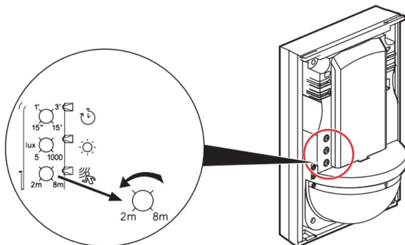
Pour réduire la sensibilité du détecteur de mouvement, tournez la vis (potentiomètre) dans le sens inverse des aiguilles d'une montre. La détection se fera alors à une distance plus courte.
