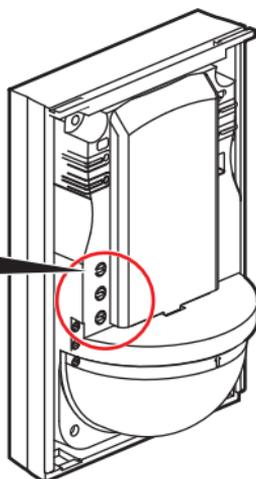
Pour augmenter la durée pendant laquelle le produit associé reste allumé (ex. : lumière), tournez la vis (potentiomètre) dans le sens des aiguilles d'une montre.
