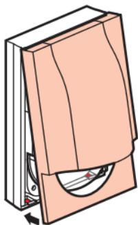
Pour une installation en extérieur avec degré de protection IP44
