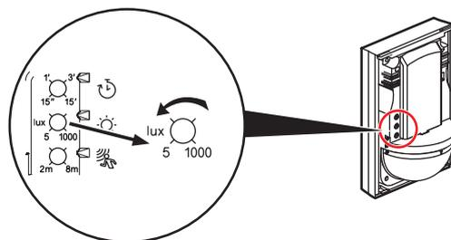
Pour que le détecteur se déclenche uniquement lorsqu'il fait sombre, tournez la vis (potentiomètre) dans le sens inverse des aiguilles d'une montre.
