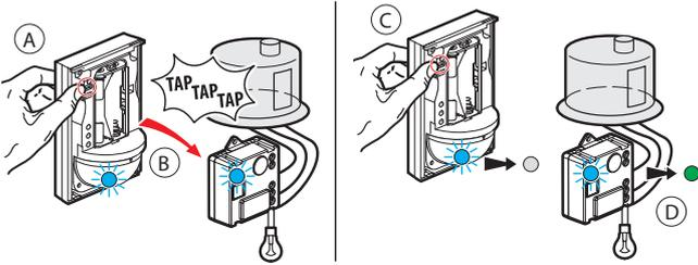
Etape A : Maintenez appuyé votre doigt sur le bouton ON du détecteur de mouvement sans fil en tapotant 3 fois avec ce détecteur sur le micromodule connecté que vous souhaitez commander.
