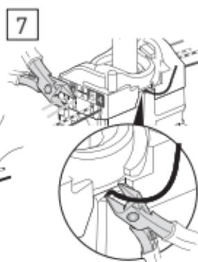
Dans le cadre d'un ajout d'une prise RJ45, conserver le type de câblage initial.
