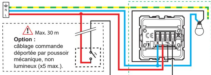
Option : câblage commande déportée par poussoir mécanique, non lumineux (x5 max.).
