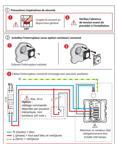
L'interrupteur (avec option variateur) connecté fonctionne avec des ampoules classiques ou à variation dont LED. L'utilisation de LED dimmables est obligatoire pour un fonctionnement optimal de l'installation en mode variation.
