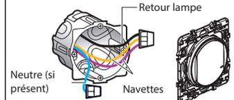
Utilisez un connecteur pour raccorder ensemble les 3 fils (retour de lampe, navettes). Utiliser un connecteur séparé pour isoler le fil de neutre.
