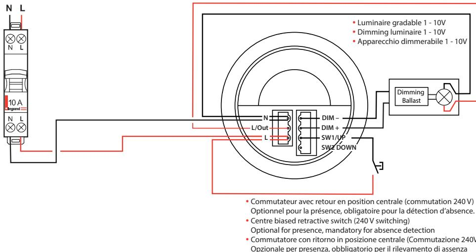
• Câblage et raccordement du bornier au détecteur
