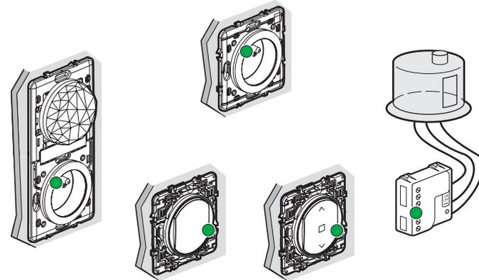
**2 Associez les commandes sans fils, sans piles pour contrôler des produits filaires connectés (interrupteur, micromodule, prise, télérupteur).**
