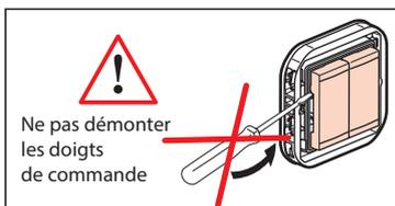
Ne pas démonter les doigts de commande
