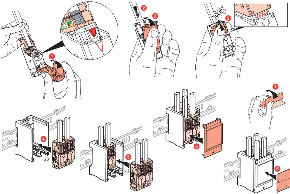
4 connecteurs supplémentaires avec support RJ 45 FTP/STP réf. 4 131 80 et connecteurs RJ 45 Cat 6 STP réf. 4 131 83 (en option)
