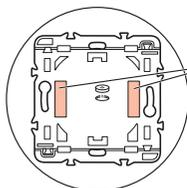
Coller les 2 adhésifs repositionnables à l'arrière de la commande sans fils.
