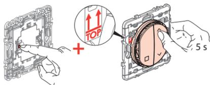
Tout en maintenant l'appui sur le bouton "configuration", appuyez sur le bouton "Montée" de la commande sans fil, sans pile pendant 5 secondes. **Validez que votre commande est correctement réinitialisée en effectuant une commande Montée, puis Descente.**
