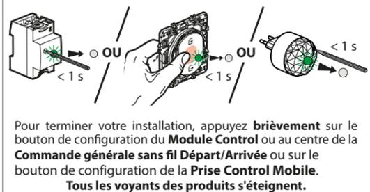
**En cas de besoin, effacez la configuration de la commande sans fil, sans pile**
