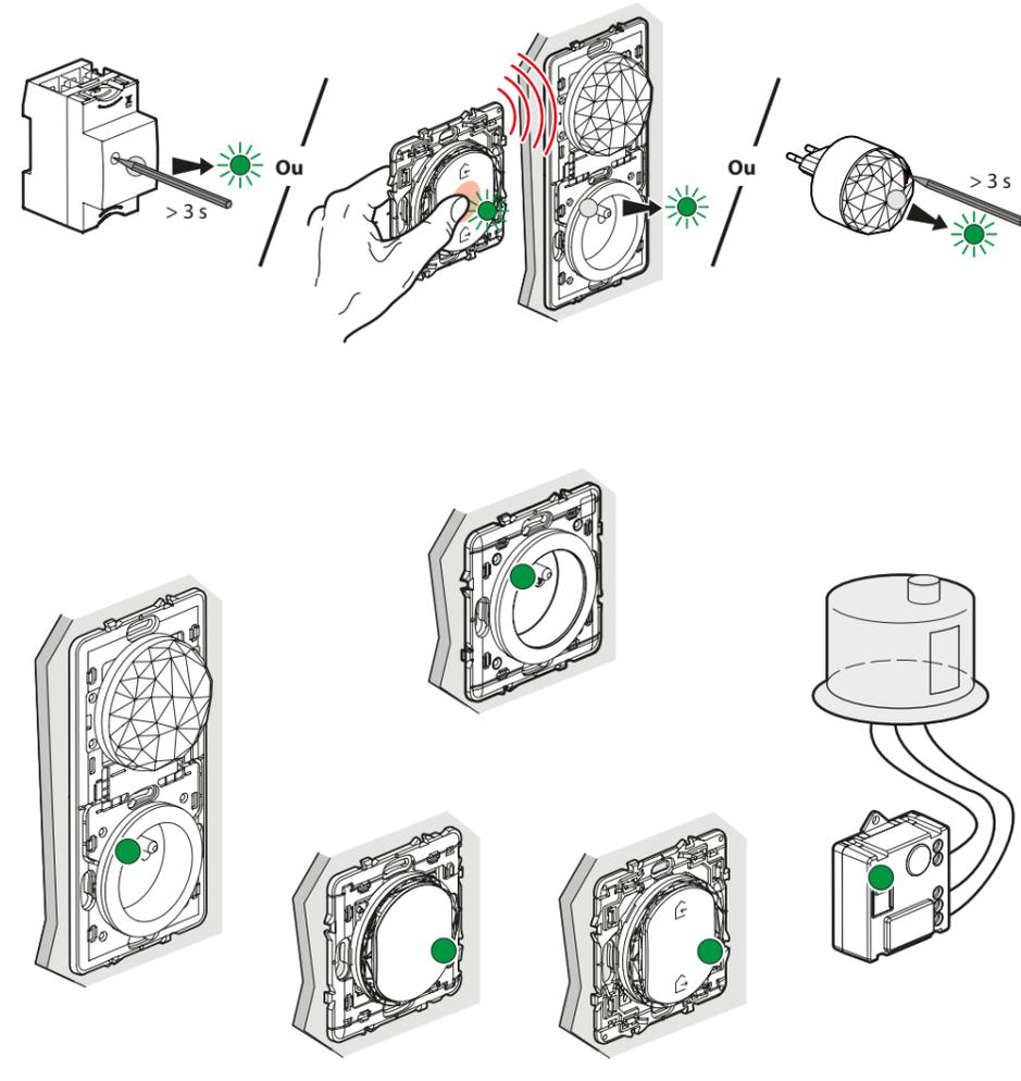
**② Associez les commandes sans fil, sans pile pour contrôler des produits filaires connectés (interrupteur, micromodule, prise, télérupteur).**
