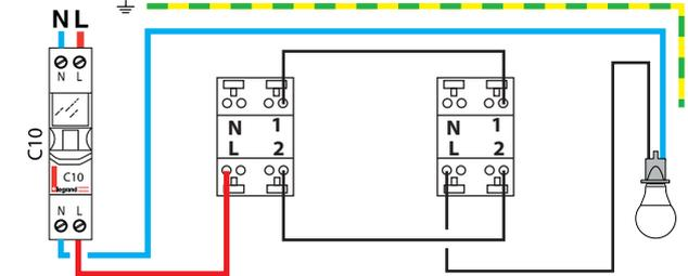
Cas du remplacement d'un va-et-vient par une Commande d'Ambiance Couleurs filaire et une Commande d'Ambiance Couleurs sans fil.
