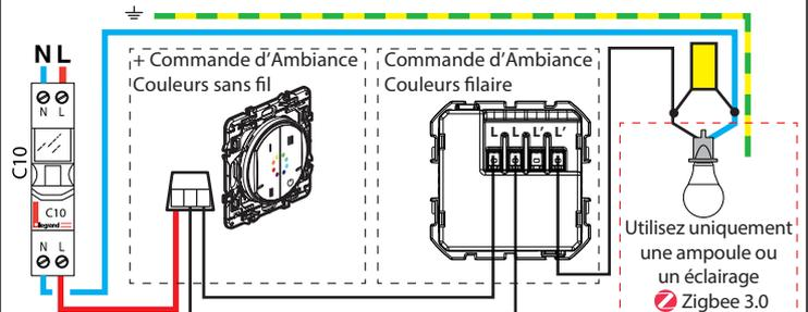
Cas du remplacement d'un Va-et-vient par 2 Commandes d'Ambiance Couleurs filaire.
