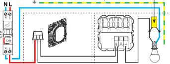
Utilisez un **connecteur** pour raccorder ensemble les 3 fils (navettes 1, 2 et retour de lampe). Utiliser un connecteur séparé pour isoler le fil du neutre (si présent).
