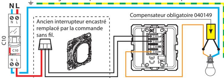
Utilisez un **connecteur** pour raccorder ensemble les 3 fils (navettes 1, 2 et retour de lampe).
