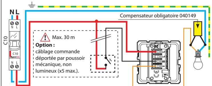
**Cas du remplacement d'un Va-et-vient :**
