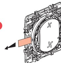
Munissez-vous **des deux** commandes sans fil **incluses dans ce pack**. Retirez la languette de protection de la pile pour alimenter les commandes.
