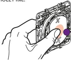
② Confirmez l'action en ré-appuyant brièvement au centre du bouton de cette commande, le voyant s'allume en ROUGE puis s'éteint. Le mode radio de la commande sans fil N°1 et du micromodule VMC est supprimé.
