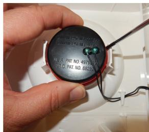
Déclipser puis retirer le buzzer le buzzer
