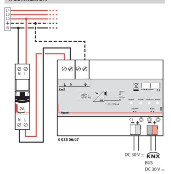
Le bus KNX doit être connecté à la borne de raccordement KNX. Assurez-vous que les câbles sont correctement raccordés en fonction de leur couleur. Les connexions électriques sont réalisées à l'aide de bornes à vis. Le nom des bornes se trouve sur le produit.
