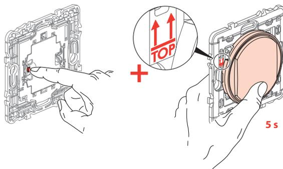
Tout en maintenant l'appui sur le bouton «configuration» de la commande sans fil, sans pile, appuyez sur le bouton BAS de la commande sans fil, sans pile pendant 5 secondes.
