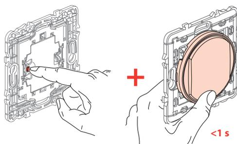
Tout en maintenant l'appui sur le bouton «configuration» de la commande sans fil, sans pile, appuyez **brèvement** sur le bouton «Départ» ou «Arrivée» de la commande sans fil, sans pile.
