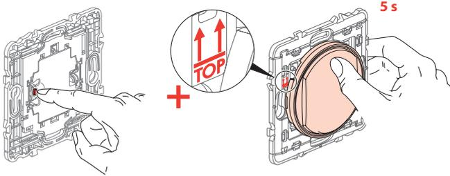
Tout en maintenant l'appui sur le bouton «configuration» de la commande sans fil, sans pile, appuyez sur le bouton HAUT de la commande sans fil, sans pile pendant 5 secondes.
