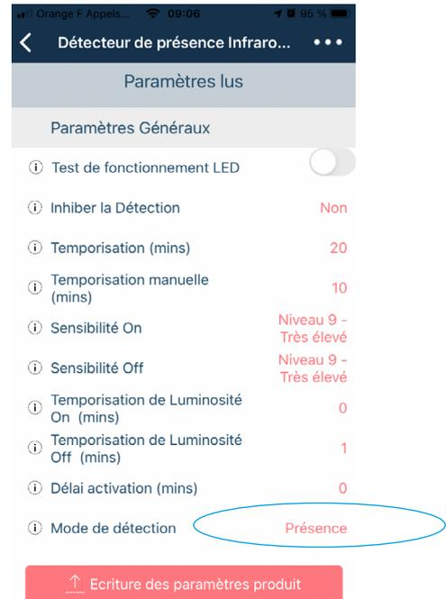
Dans les deux cas, Présence/Absence, la sensibilité au mouvement du capteur PIR peut être ajustée en utilisant le paramètre "Sensibilité".
