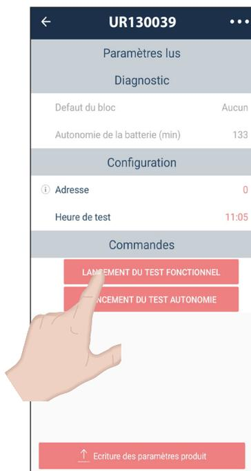
Après avoir cliqué sur test fonctionnel ou test d'autonomie, on visualise le résultat sur le bloc :
