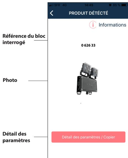
Etape 2 : Cliquer sur "DÉTAIL DES PARAMÈTRES" pour avoir accès à la liste complète des paramètres et à des informations complémentaires. Durant cette étape il faut maintenir la passerelle en direction du bloc interrogé, le chargement des paramètres est visualisable sur l'écran du téléphone.
