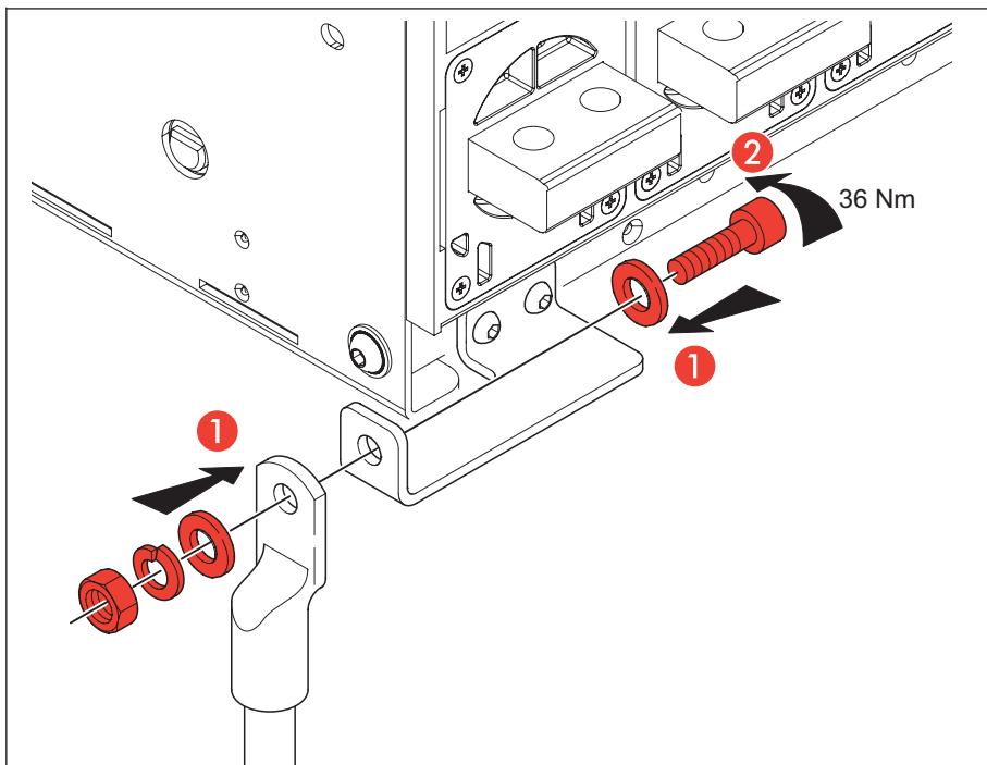
**Kit de connexion de terre pour appareil débrochable**
