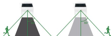
S'allume automatiquement en pleine lumière (260lm) lorsqu'un mouvement est détecté dans un rayon  $\leq 6m$  et reste ensuite allumé à 3% de luminosité pendant 20 secondes si aucun mouvement n'est à nouveau détecté
