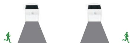
S'allume automatiquement au crépuscule (<30lux) et reste lumineux à 20%, pendant 5 heures puis extinction.
