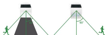
S'allume automatiquement en pleine lumière (260lm) lorsqu'un mouvement est détecté dans un rayon  $\leq 6m$  et s'éteindra après 30 secondes si aucun mouvement n'est à nouveau détecté.
