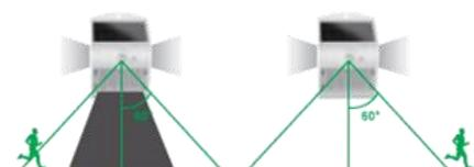
Mode B : S'allume automatiquement en pleine lumière (220lm) lorsqu'un mouvement est détecté dans un rayon  $\leq 6m$  et s'éteindra après 10 secondes si aucun mouvement n'est à nouveau détecté.
