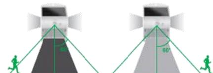
Mode A : S'allume automatiquement en pleine lumière (220lm) lorsqu'un mouvement est détecté dans un rayon  $\leq 6m$  et reste ensuite allumé à faible luminosité après 10 secondes (lumière frontale et arrière) si aucun mouvement n'est à nouveau détecté.
