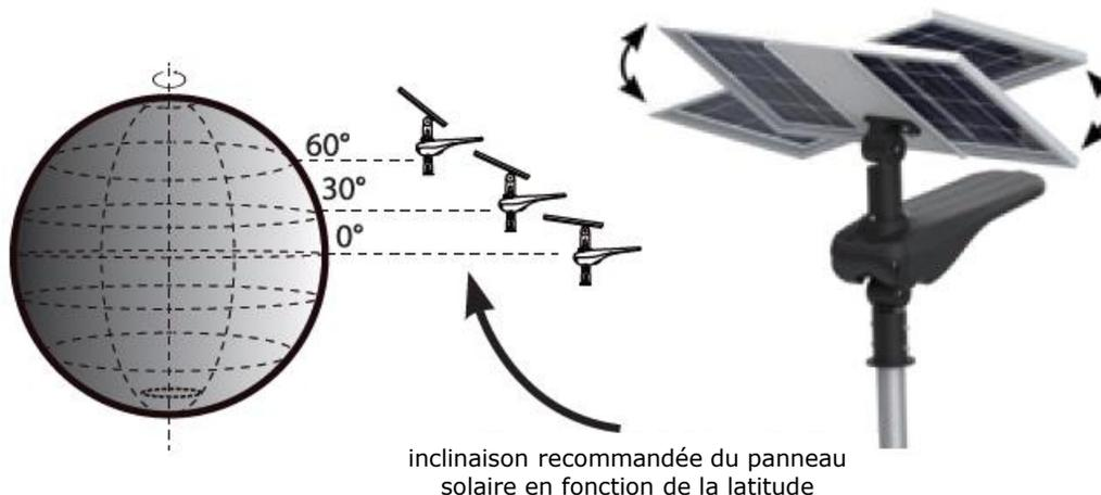
inclinaison recommandée du panneau solaire en fonction de la latitude
