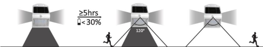
S'allume automatiquement au crépuscule et reste à 50 % de luminosité.
