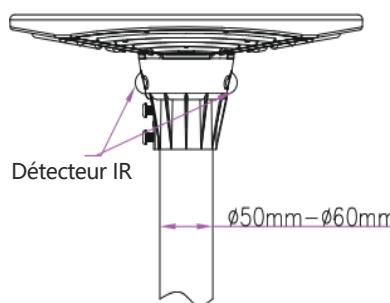
Ce luminaire tête de mât est équipé de deux détecteurs de mouvement.
