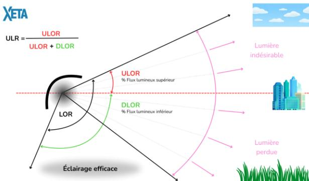
ULR (Upward Light Ratio) correspond au rapport du flux sortant émis dans l'hémisphère supérieur par rapport au flux total sortant des luminaires, lesquels étant dans leur position d'installation. Il permet de limiter le flux lumineux émis vers le ciel et donc inutile. Cette valeur doit être inférieure en nominale à 1%.
