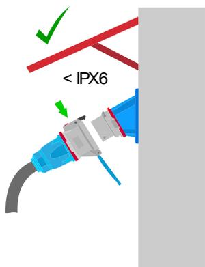
• Cuando o conector de um equipamento com grau de proteção o inferior a IPX6 está voltado para baixo, a tomada móvel não está protegida contra a entrada de água da chuva. Este conector deve ser protegido.
