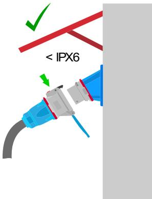
• Wenn die Einbaustecker von eines Geräts mit Schutzart unter IPX6 nach unten gerichtet ist, schützt er nicht die entsprechende Kupplungsdose gegen Tropfwasser. Bitte schützen Sie in diesem Fall die Geräte vor Wassertropfen.
