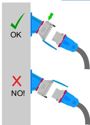
• Розетки имеют фиксирующую защелку с кнопкой. Установите устройства так, чтобы кнопка была сверху.
