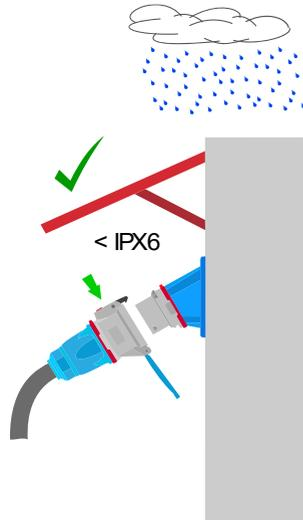
• Cuando el conector de un equipo con un grado de protección inferior a IPX6 está orientado hacia abajo, la toma móvil no está protegida contra la entrada de agua de lluvia. Este conector debe estar protegido.
