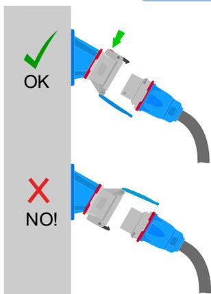
• As tomadas possuem gancho de retenção com botão. Instale os dispositivos de forma que o botão fique na parte superior.
