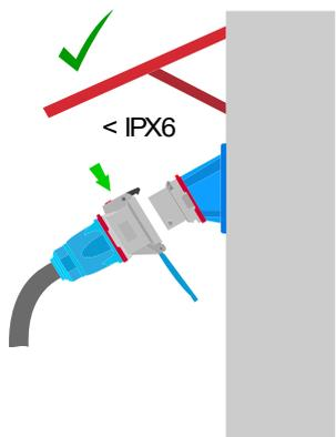
• Quando la spina fissa di un apparecchio con grado di protezione inferiore a IPX6 è orientata verso il basso, la presa mobile non è protetta dalla penetrazione dell'acqua piovana. Questa spina fissa deve essere protetta.
