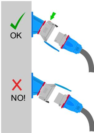
• Die Einbaudosen haben einen Auslösehaken mit einem Knopf. Installieren Sie die Geräte so, dass sich der Haken oben befindet.
