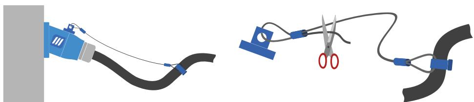
**GUIDA CAVETTO :** Su alcune impugnature è previsto un guida cavetto, che garantisce un'angolazione ottimale della trazione del dispositivo di espulsione.
