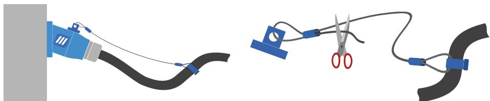
**GUIDE FILIN :** Certaines poignées sont munies d'un guide filin. Ce guide filin permet que la traction soit exercée sur le dispositif d'éjection avec un angle optimal.
