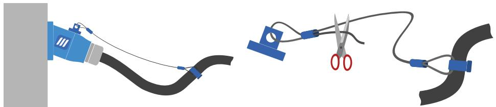
Натяжной шнур имеет петлю на одном конце и кабельную стяжку для зажима силового кабеля. Зажим для обжима позволяет закрепить петлей на другом конце, после того, как он пройдет к разъединяющему устройству, и отрезать желаемую длину.
