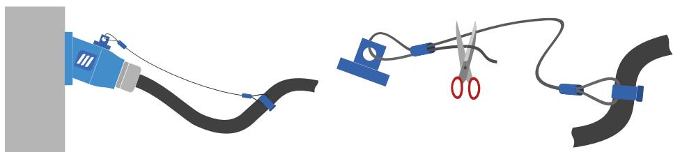
Il cavo di tensione è provvisto, ad un'estremità, di un anello e di un morsetto per il suo fissaggio al cavo di alimentazione o ad un punto fisso dell'impianto. Viene fornito un terminale a crimpare per avvolgere l'altra estremità del filo dopo essere passato attraverso il dispositivo e tagliato alla lunghezza desiderata.
