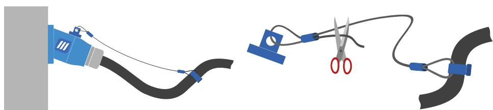
O cabo de tensão é fornecido, numa extremidade, com um laço e uma braçadeira para fixação ao cabo de alimentação (ou a um ponto fixo da instalação). Um terminal de crimpagem é fornecido para enrolar a outra extremidade do cabo depois de passar pelo dispositivo e cortá-lo no comprimento desejado.
