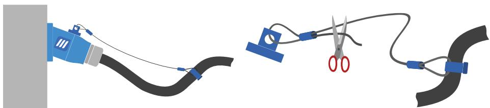
Le filin de tension est muni, à une extrémité, d'une boucle et d'un collier de serrage pour sa fixation au câble d'alimentation ou à un point fixe. Une cosse à sertir est fournie pour boucler l'autre extrémité du filin après passage dans le mécanisme et recoupe à la longueur désirée.
