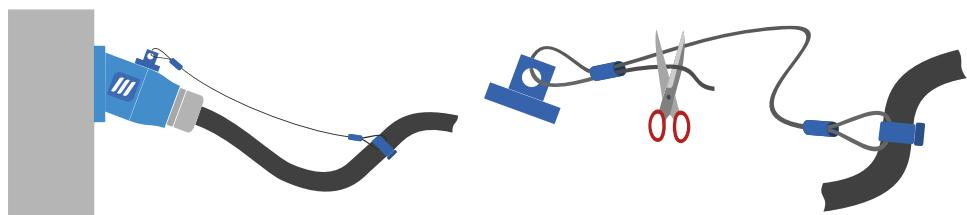
El cable de tensión se proporciona, en un extremo, con un bucle y una abrazadera para su fijación al cable de alimentación (o a un punto fijo de la instalación). Se proporciona un terminal de crimpado para enrollar el otro extremo del cable después de pasar a través del dispositivo y cortarlo a la longitud deseada.
