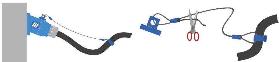
Die Kordel ist an einem Ende mit einer Schlaufe und einer Klemme zur Befestigung am Stromkabel befestigt (oder an einem festen Punkt der Anlage). Ein Stossverbinder wird bereitgestellt, um das andere Ende der Kordel zu schlingen, nachdem sie durch das Gerät geführt und auf die gewünschte Länge geschnitten wurde.
