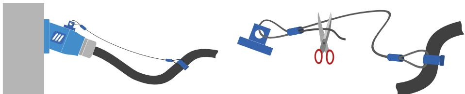
**GUIDE FILIN :** Certaines poignées sont munies d'un guide filin. Ce guide filin permet que la traction soit exercée sur le dispositif d'éjection avec un angle optimal.
