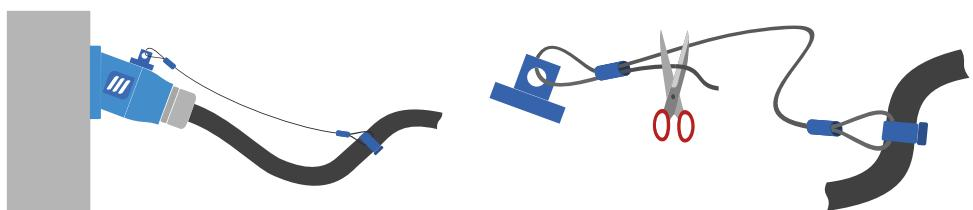
**GUÍA PARA HILO :** Algunas empuñaduras incluyen una guía que permite un ángulo óptimo de tracción del dispositivo de eyección.
