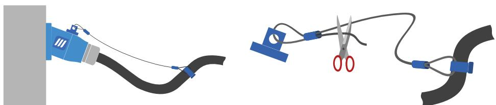
УШКА : Некоторые ручки оснащены пластиковыми ушками. Они обеспечивают оптимальный угол натяжения натяжного шнура на механизме отпуска защелок.
