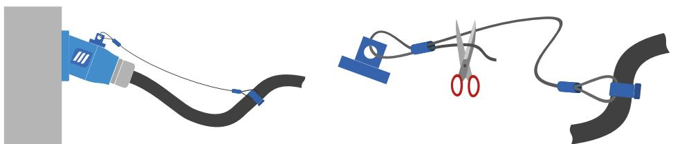
KORDELFÜHRUNG : Bei einigen Griffen wird eine Führung geliefert. Diese sorgt dafür, dass der Zug auf den Auswurf-Mechanismus in einem optimalen Winkel erfolgt.
