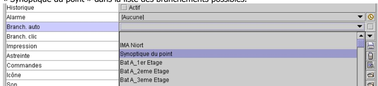
Lors du fonctionnement du point au sein de CASTELSuperviseur, le branchement automatique se fera sur le synoptique du point
